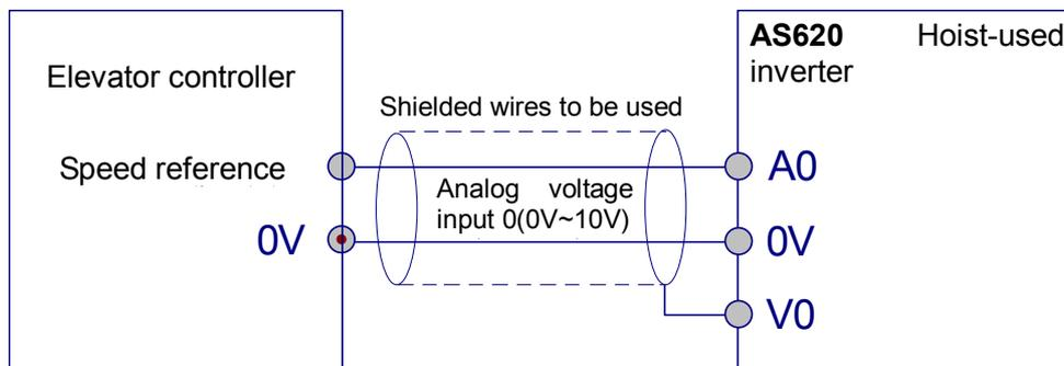
Fig- 4.19 AIO wiring
